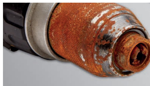
Rusten borepatron – efterladt i udendørs elementer
