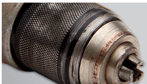
Beskadiget borepatron – værktøjet er ikke behandlet ordentligt
